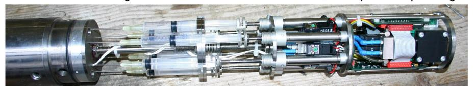
Neue Beprobungseinheit mit Pneumatikzylinder und 6 Spritzen
