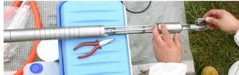
Probenentnahme-System zur tiefenorientierten Beprobung mit eingesetztem „headspace-Rollrandglas“
